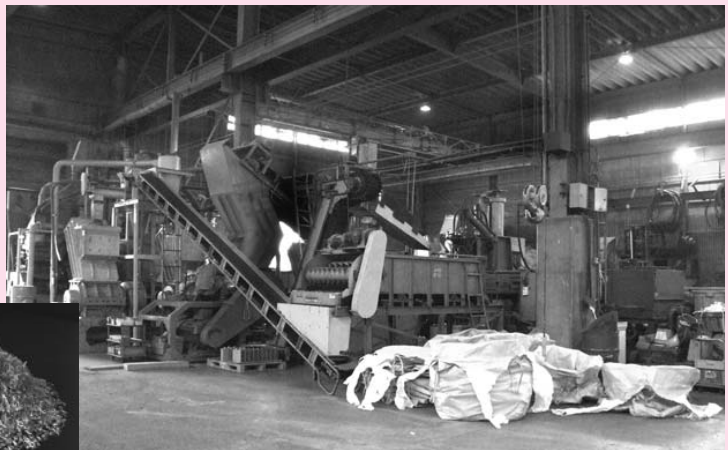
被覆電線を裁断し、銅線と被覆材を分離させる装置
